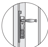
Rys. 5. Furtka z zamkiem elektromagnetycznym, klamka zablokowana.
